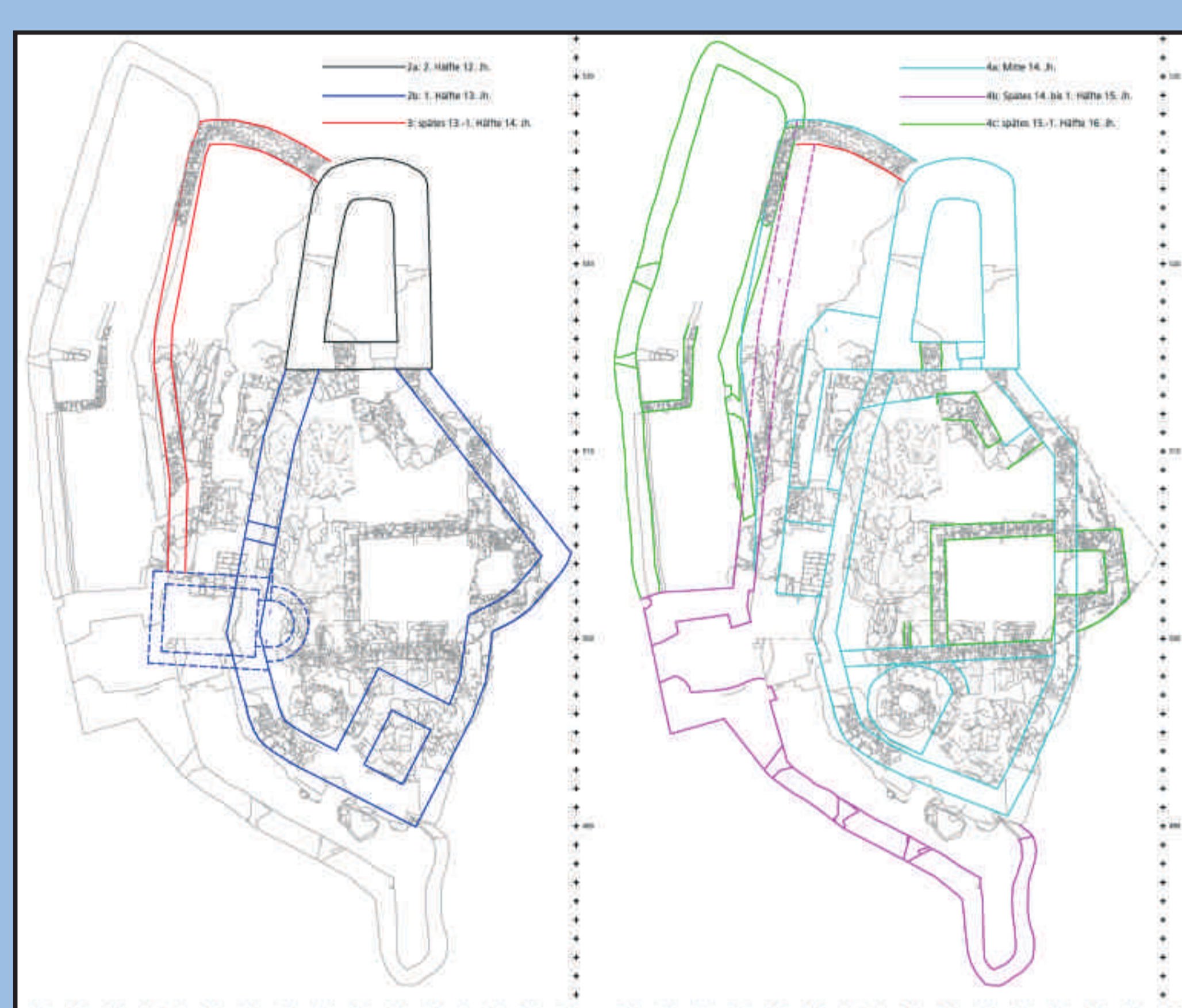
Zwei Bauphasen: links 12. - 14., rechts 14. - 16. Jahrhundert
